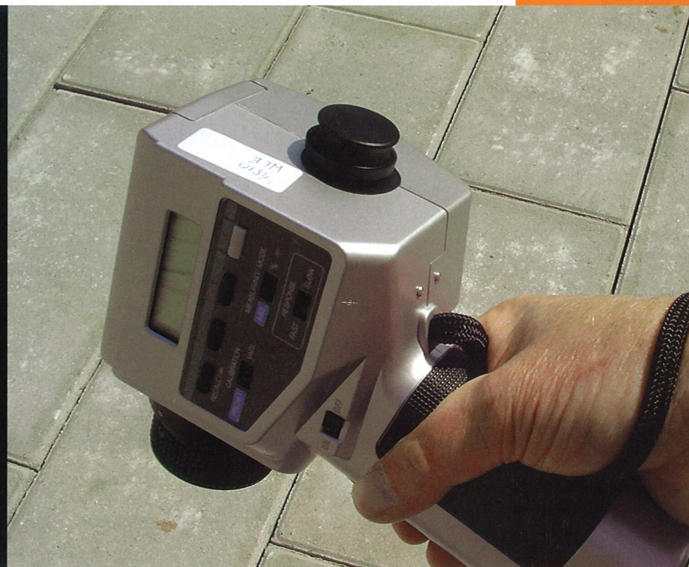
Met een luminantiemeter wordt het helderheidscontrast tussen verschillende materialen bepaald.
